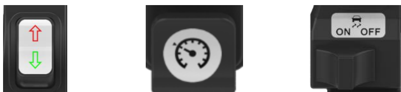
Obrázek 26. Směrové spínače a indikátory (od L do P); Walk; Cruise; Traction.
