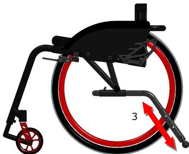
Obr. 16. Vozík – se stabilizačním kolečkem: a) vytaženým na maximum k podlaze,
