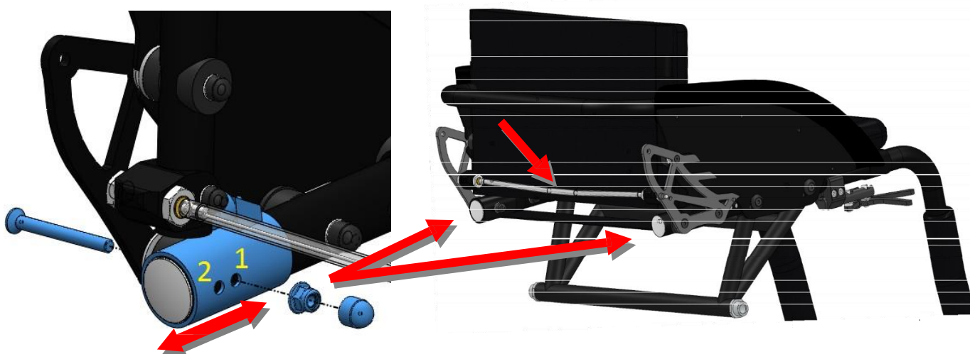
Obr. 5a. Způsob, jak změnit nastavení zadního aretačního zámku. Obr. 5b. Lanko sklápěcího mechanismu zádové opěry.
