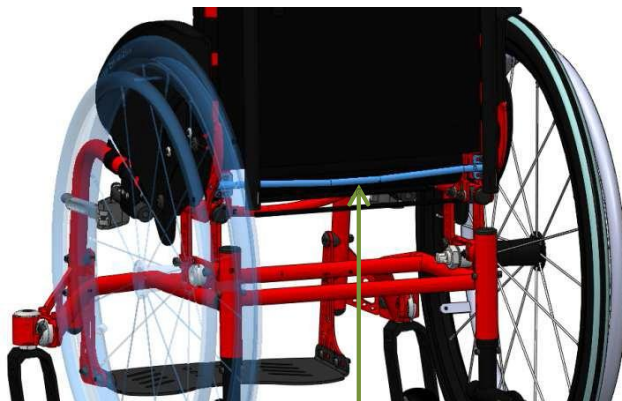
Obrázek 17. Lanko pro seřízení a sklopení zádové opěrky
